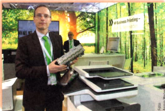
Stephan Batteux, Manager Inkjet Printer Portfolio bei HP, zeigt den seitenebenen Druckkopf, der das Herzstück der PageWide-Tintenstrahler bildet.
